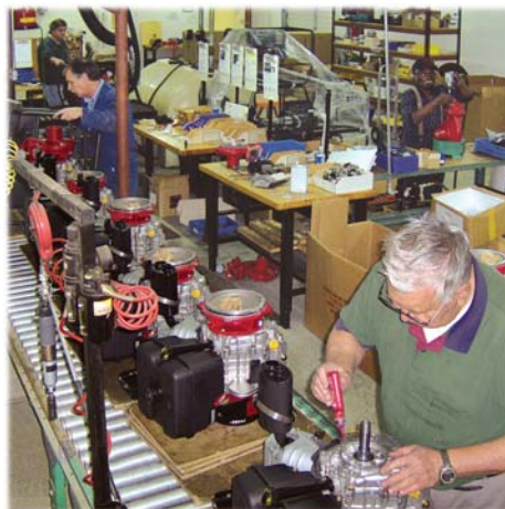
Bombas Riverside construidas a mano
